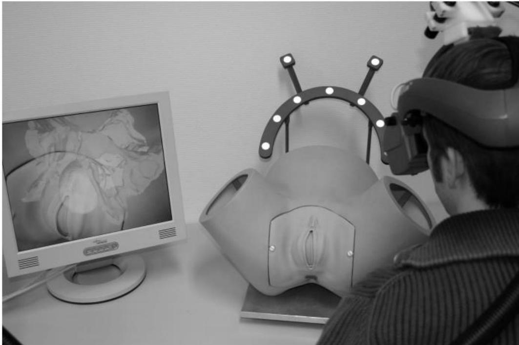
*Figure 12 Superposition de l'image virtuelle montrant un nouveau né sur l'image réelle d'un mannequin de soin, l'utilisateur dispose de deux dispositifs d'affichage sur cette image. [13]*
